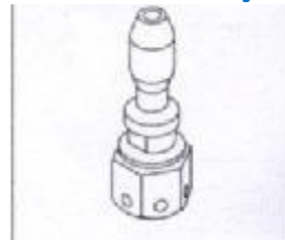
H 10-18 Tubo de Ventilação
